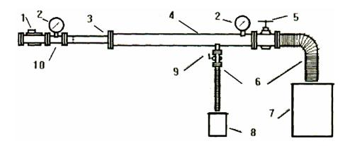
1 — расходомер; 2 — манометры; 3 — пеногенератор; 4 — основной трубопровод; 5 — задвижка; 6 — эластичные рукава; 7, 8 — емкости на 2000 и 10 л; 9 — шаровой кран; 10 — дополнительный трубопровод
